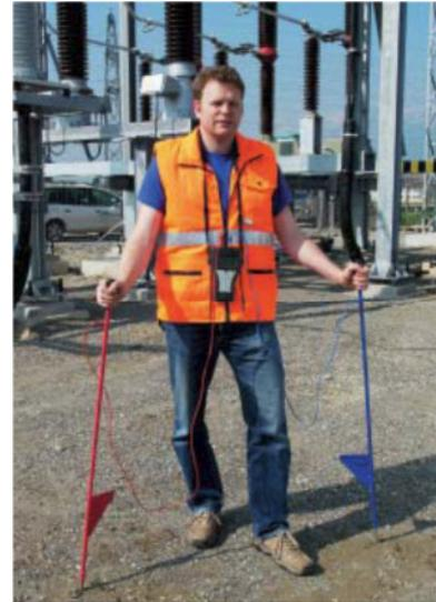
Mantelfehler grenzt die Vorortung mit shirla auf wenige Meter genau ein. Mit der Schrittspannungsmethode und den entsprechenden Handgeräten erfolgt die Nachortung schnell und präzise.
