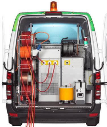
Die neuen BAUR-Kabelmesswagen mit 3,5 Tonnen Gesamtgewicht erlauben auch die automatische Kabelprüfung, -diagnose und Fehlerortung bis 80 kV und bringen dank der BAUR Systemsoftware 3.3. etliche neue Funktionen mit.
