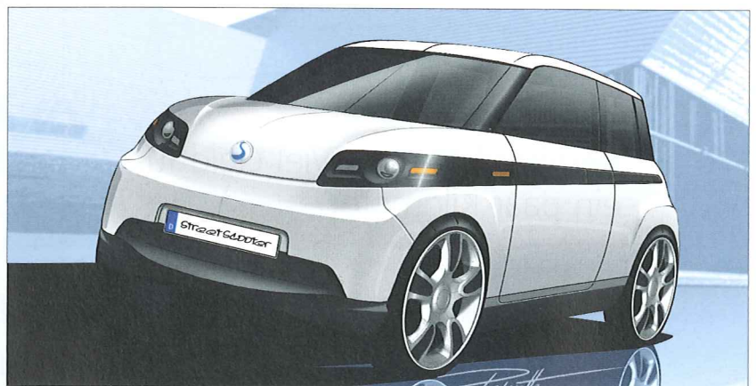
Bild 1. Der Streetscooter der RWTH Aachen kann nach einem Baukastenprinzip an verschiedene Anforderungen angepasst werden
