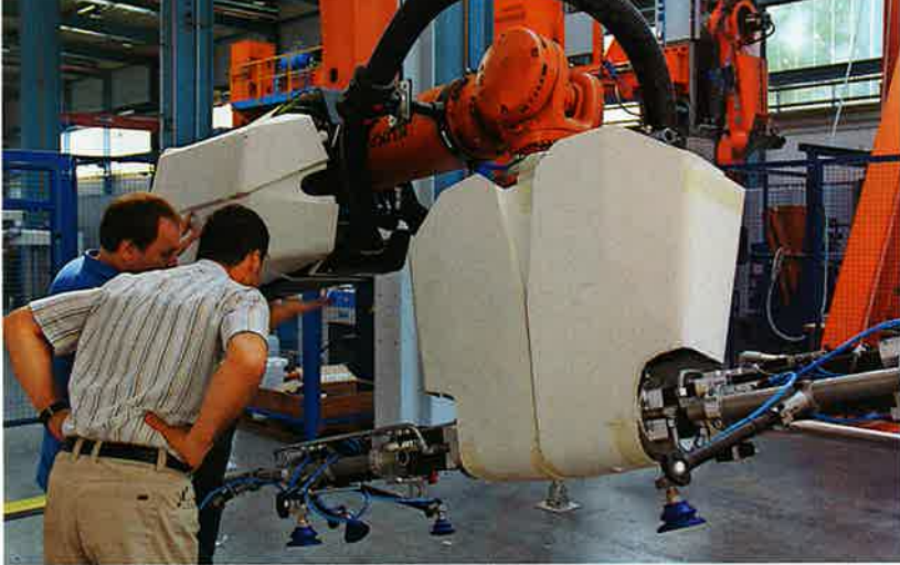
Ob die Verkleidung wirklich funktioniert, wurde mit einem 1:1-Modell aus Karton in der Realität überprüft.
