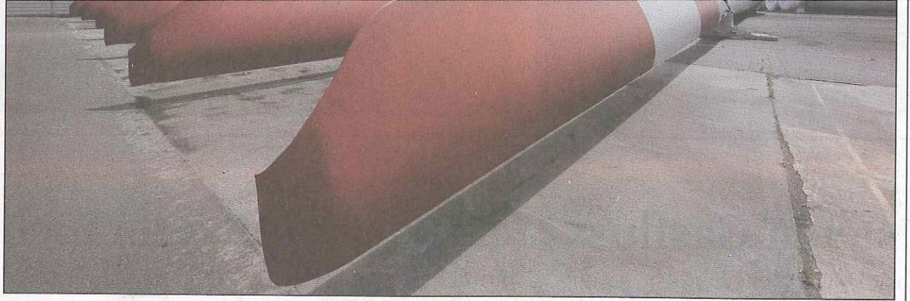
**Warten auf Arbeit.** Knapp 60 m lang und etwa 28 t schwer sind die Offshore-Rotorblätter, die vor der Fertigungshalle der Bard Emden Energy auf den
