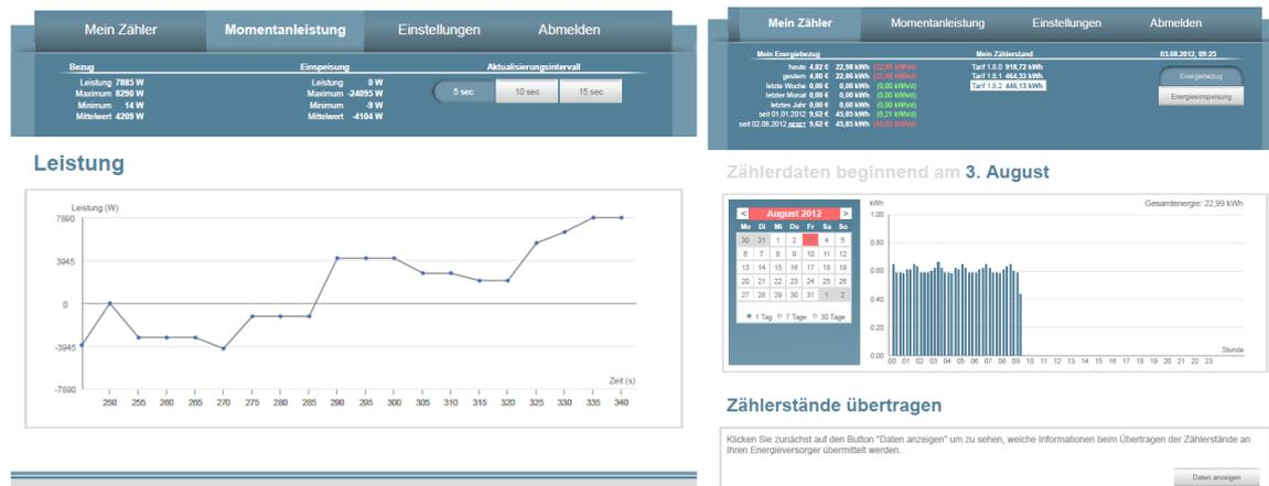
Dank des im Smart Grid Hub integrierten Webservers lassen sich die eigenen Verbrauchswerte auf dem Computer anzeigen und analysieren. Die Daten müssen das Haus dafür nicht verlassen.
