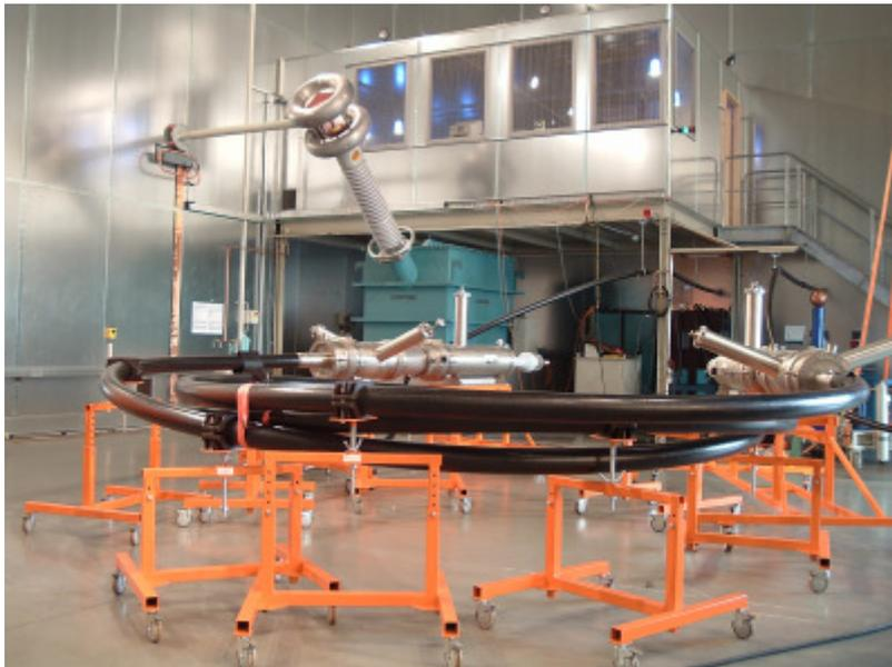
Praxisreife bewiesen: Im Labor arbeitete das Super-3C-Kabel auf Basis moderner Supraleiter-Bänder nicht nur bei Nennbelastung, sondern auch bei Kurzschlussströmen einwandfrei. Für maximale Praxisrelevanz sorgt der Systemaufbau inklusive der Kryotechnik und der Kabelendverschlüsse.
