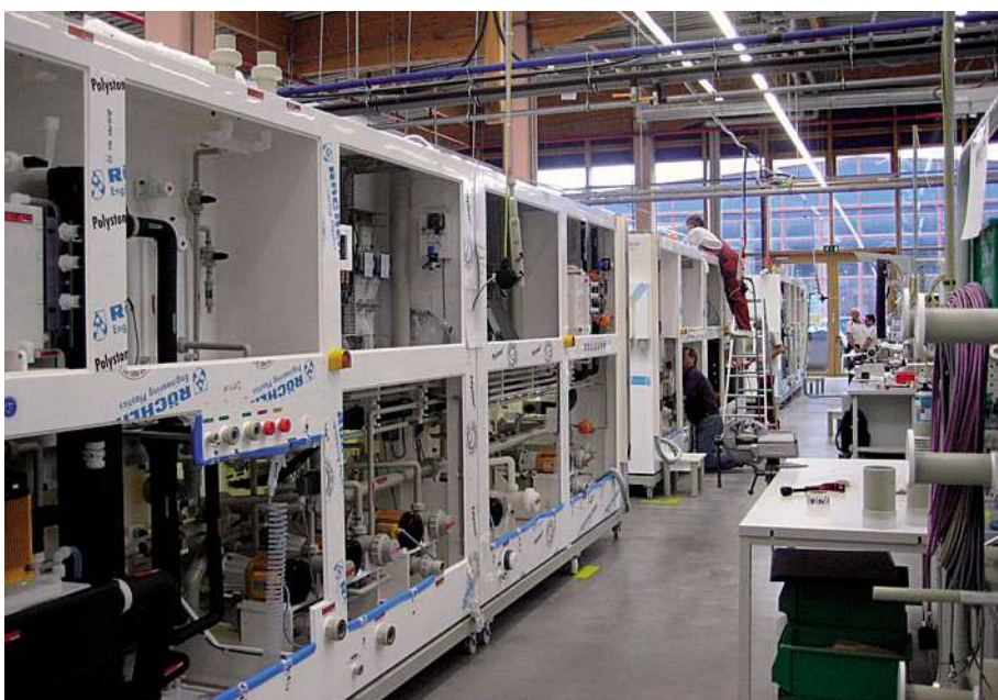
Bild 3: Der erste Schlüssel zum Erfolg war die Umstellung auf Fließfertigung. Dadurch hat es Rena 2009 geschafft, die Durchlaufzeit schon einmal um 50% zu reduzieren.
