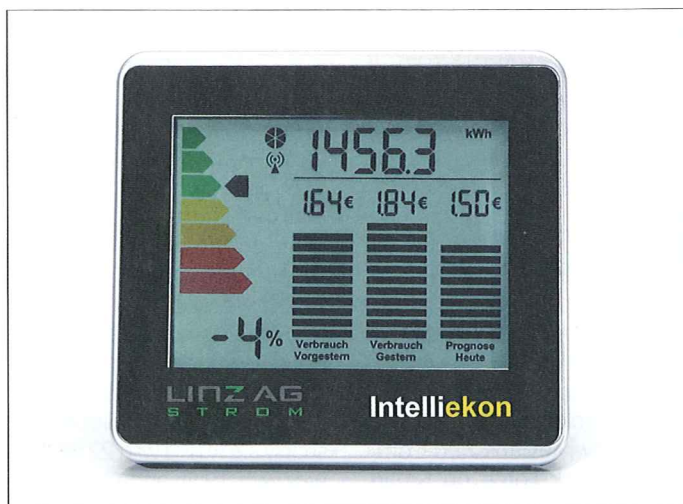
Eine Energiesparampel im Display zeigt den Stromverbrauch im Vergleich zum vorher festgelegten Energiesparziel und gibt die Energieeffizienz im Vergleich zum Energiesparziel in Prozent an
