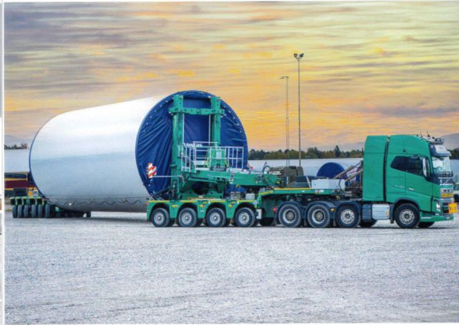
Mit dem Goldhofer RA 2-110 lassen sich Turmsegmente mit maximal 110 t Gewicht und bis zu 6,8 m Durchmesser transportieren.
