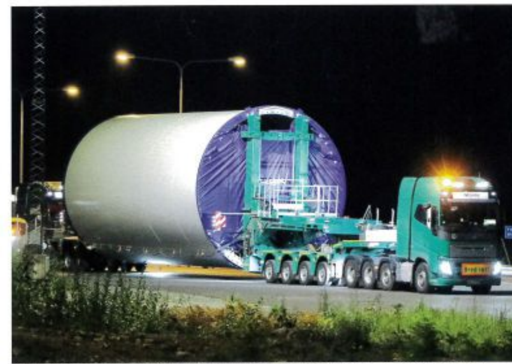
Turmsegment der EnVentus Turbine V162 auf dem Weg zum Windpark Riskebo – Goldhofer RA 2-110 in Aktion.
