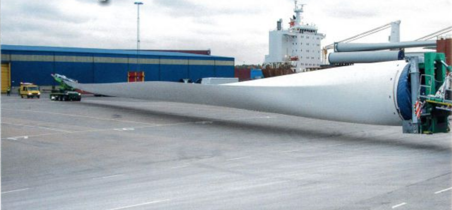
Goldhofer »BLADES«, Interface und Vestas-Klammer: einmal lang für modernste Rotorblätter ...
