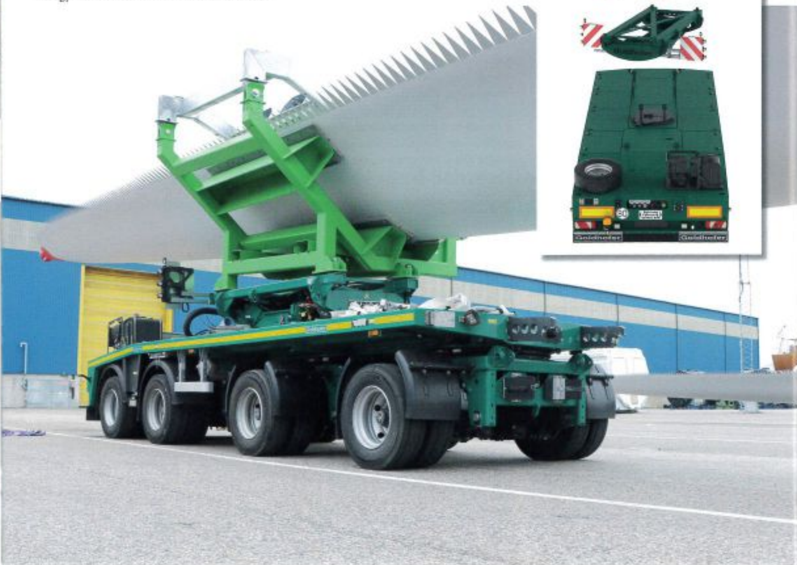
Der luftgefederte Nachläufer mit neuem Goldhofer Interface und Vestas-Klammer sorgt für erschütterungsarme Flügeltransporte.
