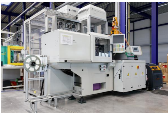
Die zehn Spritzgießmaschinen der SOMA GmbH & Co. KG müssen zu jeder Jahreszeit gekühlt werden.
