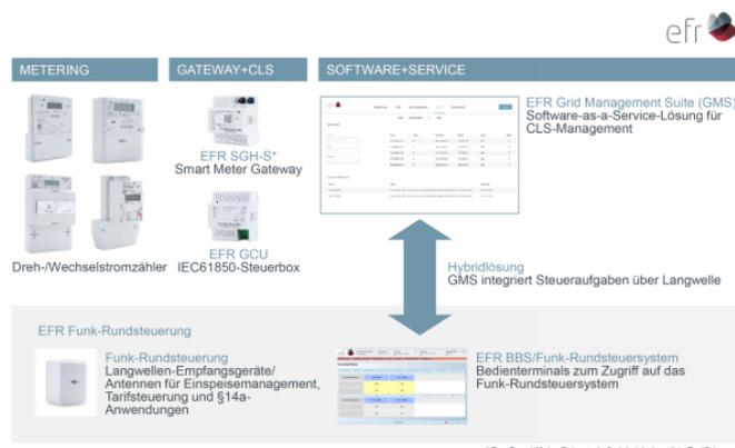
*Dank der Hybridlösung lassen sich in der „GMS“ von EFR Systeme für die bidirektionale Kommunikation und die Langwellen-Funkrundsteuerung in einer Oberfläche bedienen. (Bild: EFR)*
