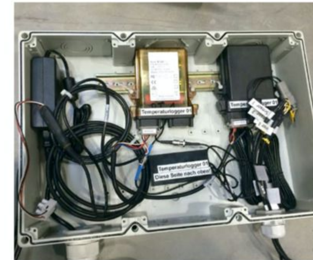
Die Orbcomm-Einheit BT 320 – verbaut in der Steuerbox.
