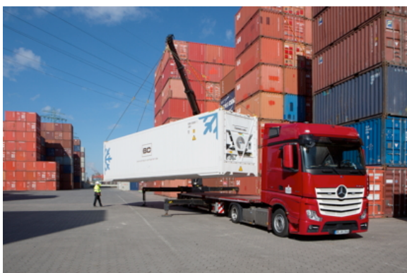
Superfreezer-Kühlcontainer für den Tiefkühl-Transport von Bakterien-Kulturen
