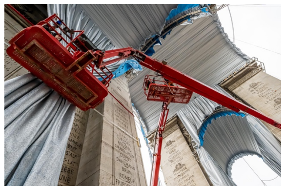
Teleskopmastbühnen, wie hier bei der Verhüllung des Arc de Triomphe, kommen auch bei den Olympischen Spielen 2024 in Paris zum Einsatz.
