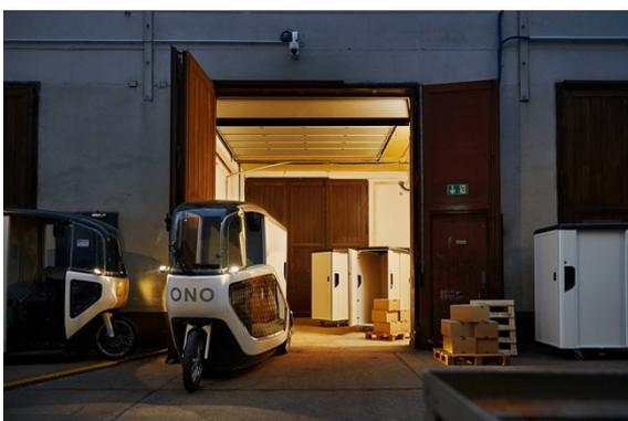
Am Microhub werden die Container von der Cargo Tram auf die ONO umgeschlagen.
