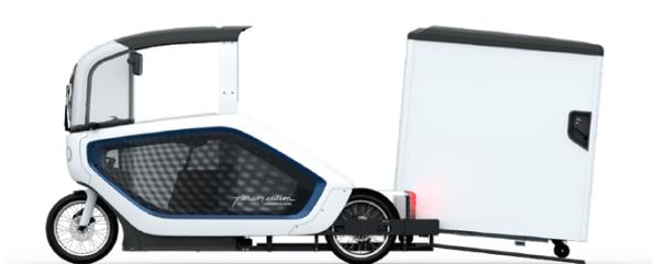
Mit einfachen Handgriffen lässt sich der Container der ONO abmontieren.
