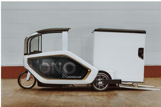
Die Cargo-Einheit lässt sich mit wenigen Handgriffen abmontieren.
