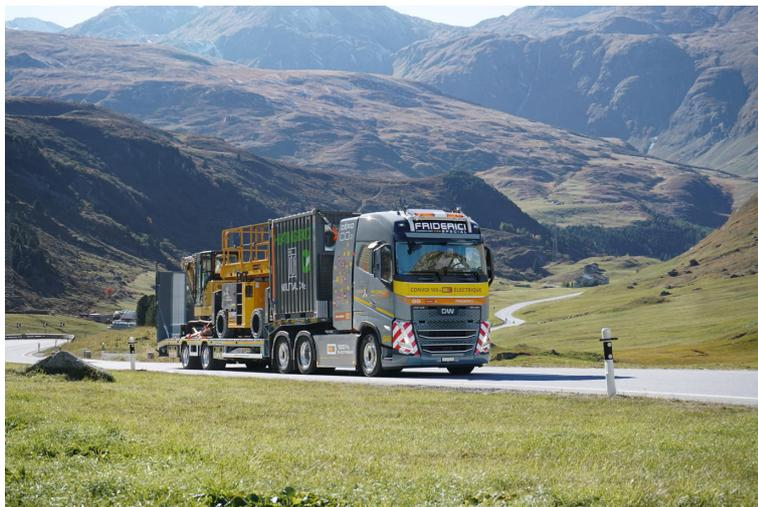
Ein elektrischer Designwerk Lkw mit 36 Tonnen und 900 kWh Batteriekapazität auf dem Weg zum Julierpass in der Schweiz.
