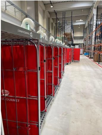
Mit den leichten Strukturkammerplatten der Roll-Safe GmbH bleiben die Rollbehälter stapelbar.
