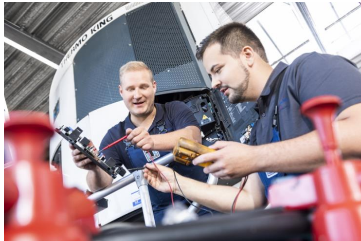
Werkstatt-Mitarbeiter bei der Prüfung der Kühlmaschinen-Elektronik (Bildquelle: Große Kracht)
