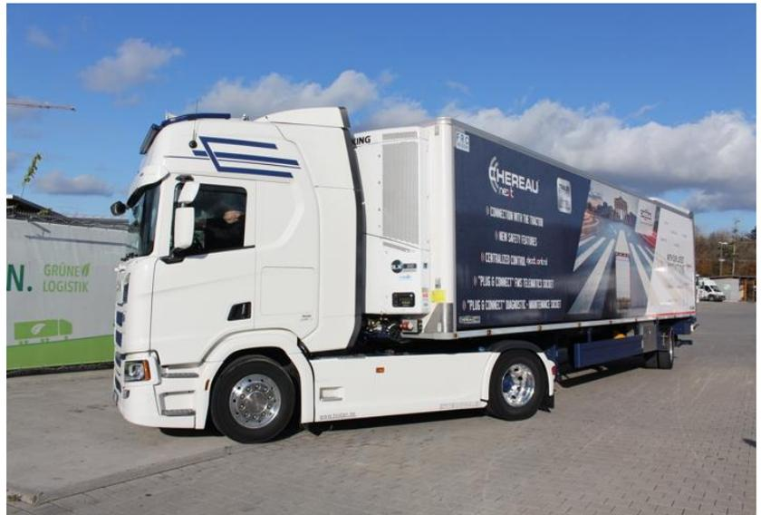
SLXi Hybrid Kühlmaschine, installiert auf dem Chereau-Trailer der Bodan GmbH
