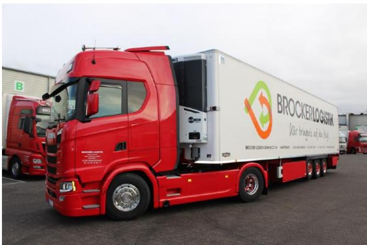
Sattelzug von Brocker Logistik mit der neuen SLXi Hybrid-Kühlmaschine von Thermo King
