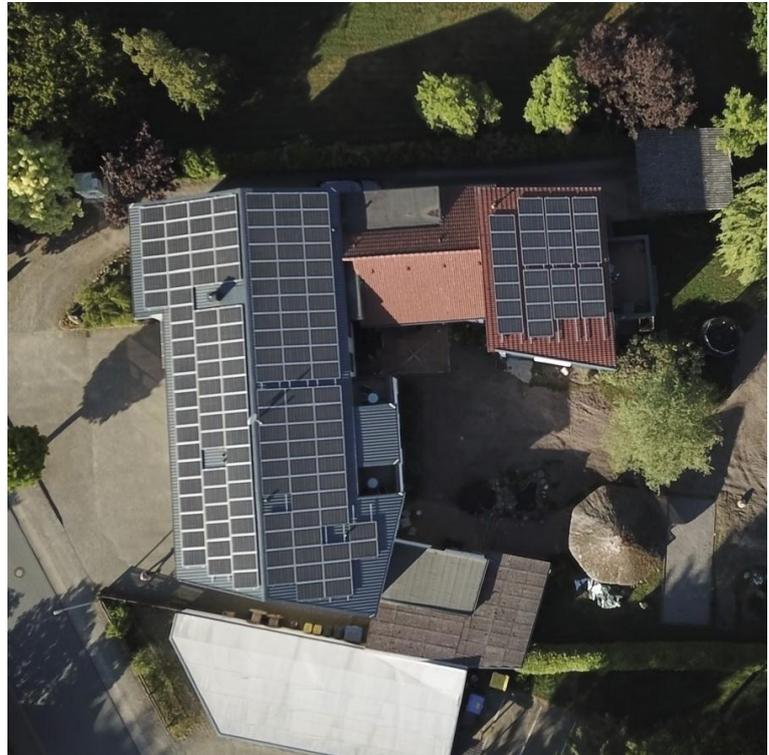
Die große Photovoltaikanlage hat eine elektrische Leistung von 64 kW<sub>peak</sub> und liefert ausreichend Strom für die Heizung, Haushaltsstrom und zum Laden von Elektrofahrzeugen. (Bild: Jörn Kaminski)
